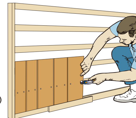
図17：葺始め列(スターター)
